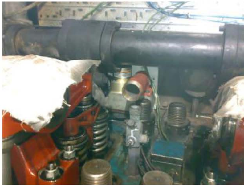
FIGURA 21 - ASPECTO DA VÁLVULA DE INJEÇÃO DE GÁS MONTADA NO COLECTOR DE ADMIÇÃO DE AR DE UM CILINDRO DE UM MOTOR WARTSILA 9L32.
