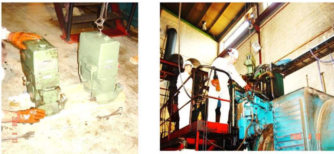
FIGURA 30 - SUBSTITUIÇÃO DO ACTUADOR ORIGINAL PELO ACTUADOR ELECTRÓNICO NUM MOTOR WARTSILA 9L32 (WOODWARD GOVERNORS).
